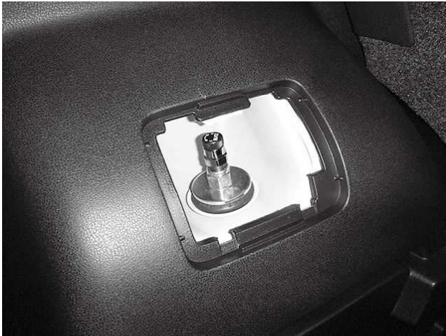
トップナット締め付け状態
