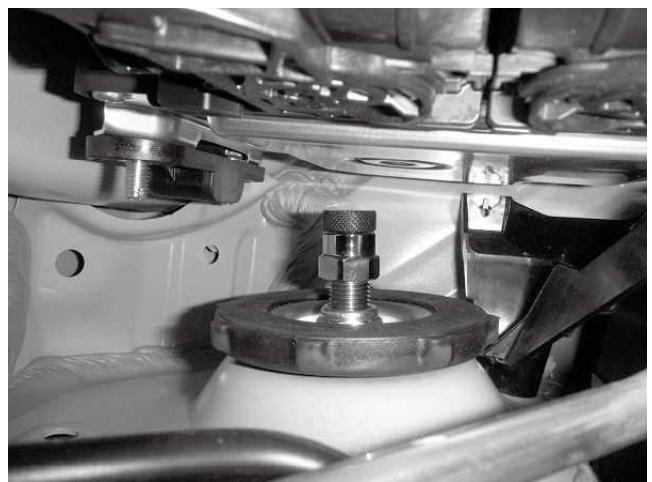
トップナット締め付け状態
