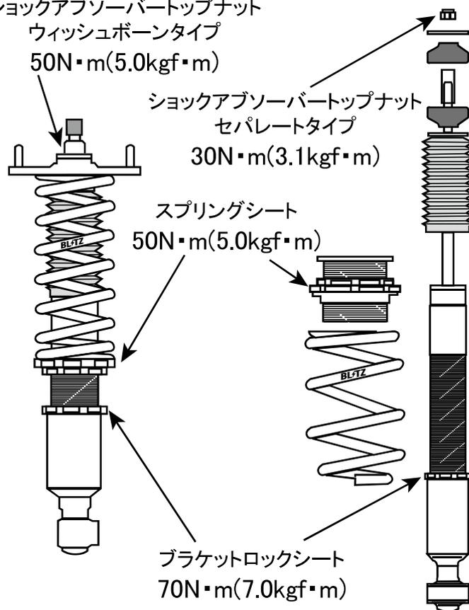
**注意** ショックアブソーバトップナット締め付けについては別ページ「トップナット締め付け方法」を参照して正しく締め付けを行ってください。
