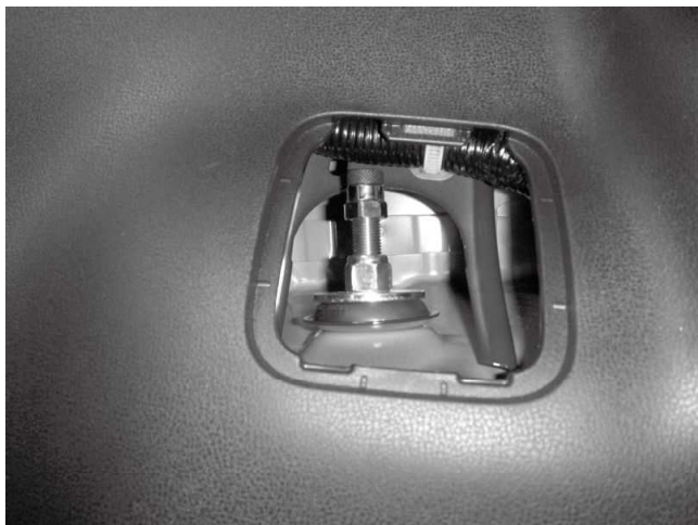
トップナット締め付け状態
