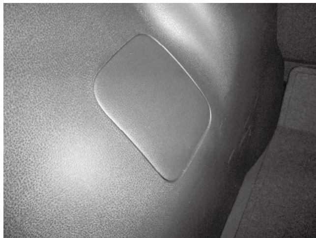
サービスパネル取り付け状態 ※左右ともサービスパネルは加工無しで 取り付けできます
