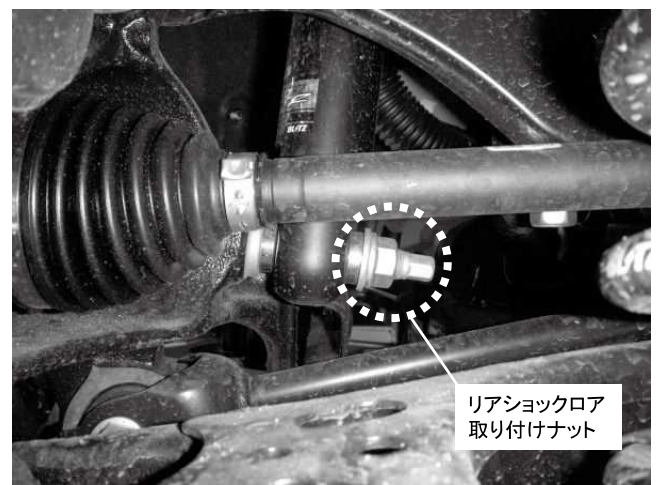
リアショックロア取り付けナット 1カ所締め付け 締め付けトルク: 125\text{N}\cdot\text{m} ( 12.7\text{kgf}\cdot\text{m} )
