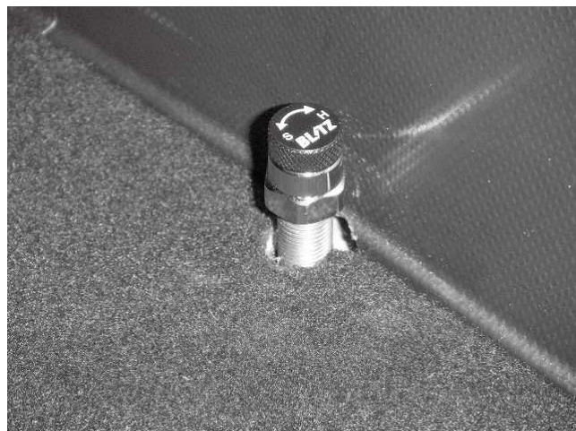
リアラゲッジトレイ(ボード)加工例 上写真では、干渉する部分を一部削っています
