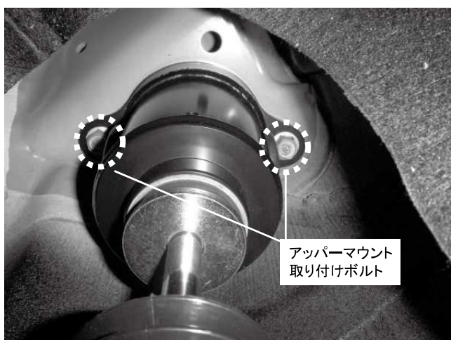
リアショックアッパーマウント取り付けボルト 2カ所締め付け 締め付けトルク: 40N・m (4.1kgf・m)
