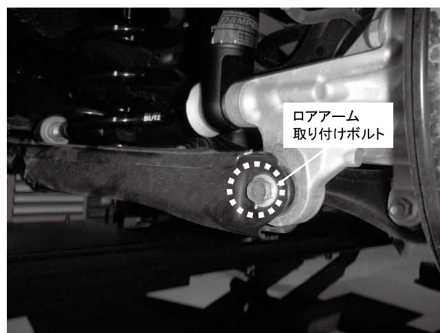
ロアアーム取り付けボルト(2WD車) 1カ所締め付け 締め付けトルク: 64\text{N}\cdot\text{m} ( 6.5\text{kgf}\cdot\text{m} )
