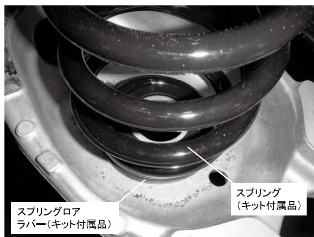
リアスプリング取り付け状態 (ロアアーム側) ※写真はAWD車の取り付け状態になります 2WDも同様取り付け方法です
