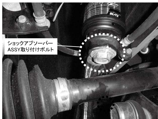
ショックアブソーバーASSY取り付けボルト 1カ所締め付け 締め付けトルク: 48N・m(4.9kgf・m)
