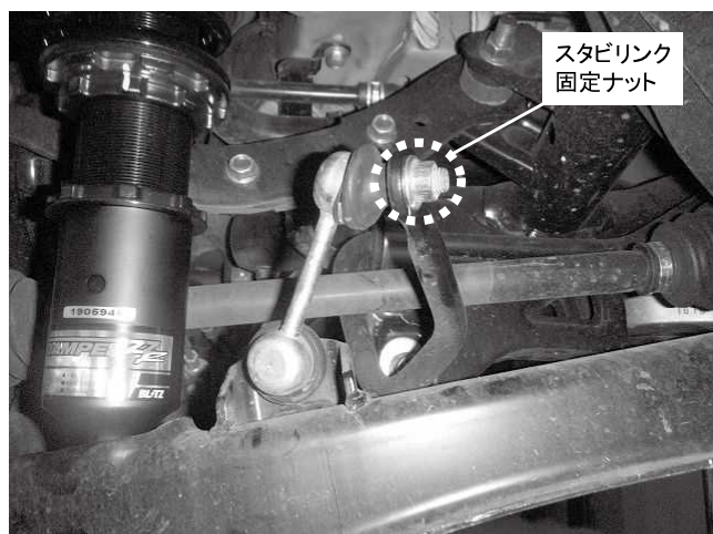
スタビリンク 固定ナット スタビリンク固定ナット 1カ所締め付け 締め付けトルク: 39N・m(3.9kgf・m)
