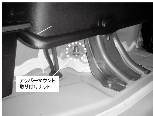
アッパーマウント 取り付けナット アッパーマウント取り付けナット 2カ所締め付け 締め付けトルク: 45N・m(4.5kgf・m) ※製品付属のM10ナットを使用してください
