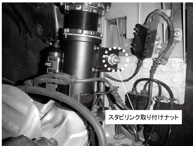
スタビリンク取り付けナット 1ヵ所締め付け
