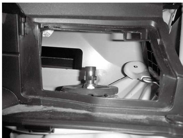
トップナット取り付け状態(助手席側) ※写真のようにサービスパネルを外すと減衰調整可能です。 調整の際以外は、必ずサービスパネルを 取り付けてください。(運転席側も同様に調整可能です)
