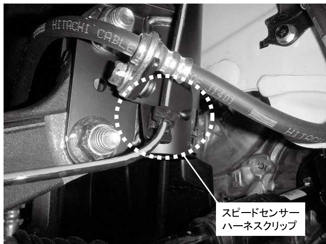
スピードセンサーのクリップ固定 クリップは純正品を取り外して使用してください
