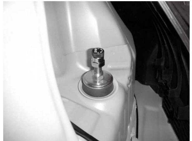
トップナット締め付け状態
