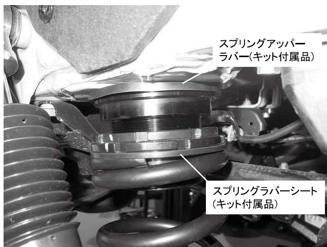
リアスプリングアッパー側取り付け状態 ※スプリングアッパーラバーと、 スプリングラバーシートが しっかりはまっているか確認してください
