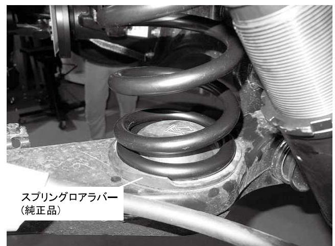
リアスプリングロア側取り付け状態 ※スプリングロアラバーがしっかりはまっているか 確認してください
