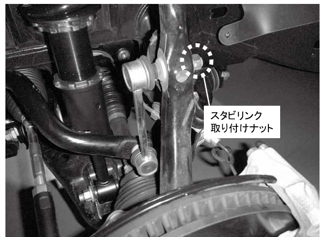
スタビリンク取り付けナット 1カ所締め付け 締め付けトルク: 70\text{N}\cdot\text{m} ( 7.1\text{kgf}\cdot\text{m} )
