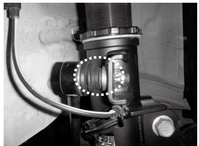
ワッシャーを入れて取り付けした状態
