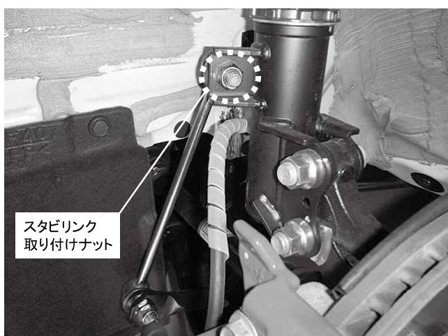
スタビリンク取り付けナット上側 1カ所締め付け
