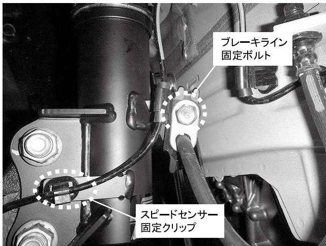
ブレーキライン固定ボルト 1カ所締め付け
