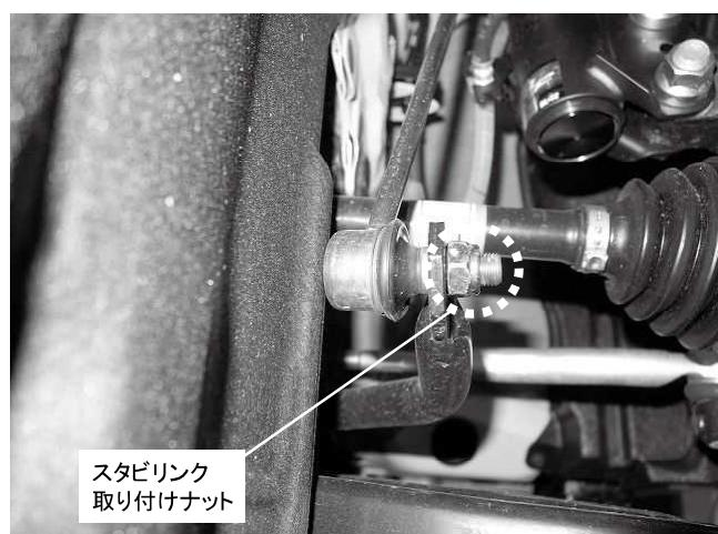
スタビリンク取り付けナット下側 1カ所締め付け
