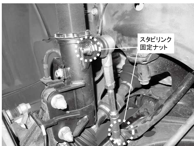
スタビリンク固定ナット 2カ所締め付け 締め付けトルク: 39N・m(3.9kgf・m) ※キット付属のスタビリンクを使用してください ※スタビリンクの長さを左右合わせて取り付けてください
