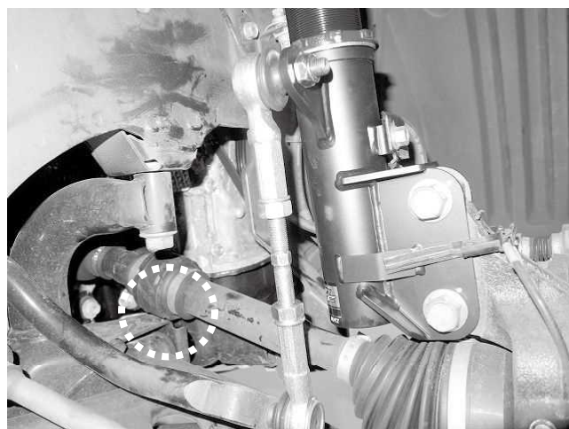
フロント右(運転席)側は車両構造上ドライブシャフトが長い為、サスペンションメンバーと、ドライブシャフトが非常に近くなります キット取り付け後は必ず干渉していないか確認してください ※写真は基準車高(寸法)の0G時状態です
