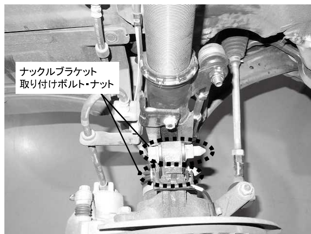
ナックルブラケット取り付けボルト・ナット 2カ所締め付け 締め付けトルク: 110N・m(11.0kgf・m)
