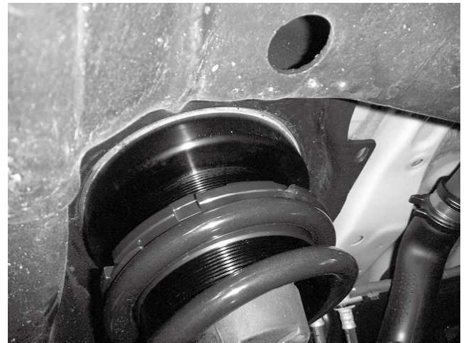
リアスプリングアッパー取り付け状態 ※ホロスプリングSUB-ASSYが しっかりはまっているか確認してください
