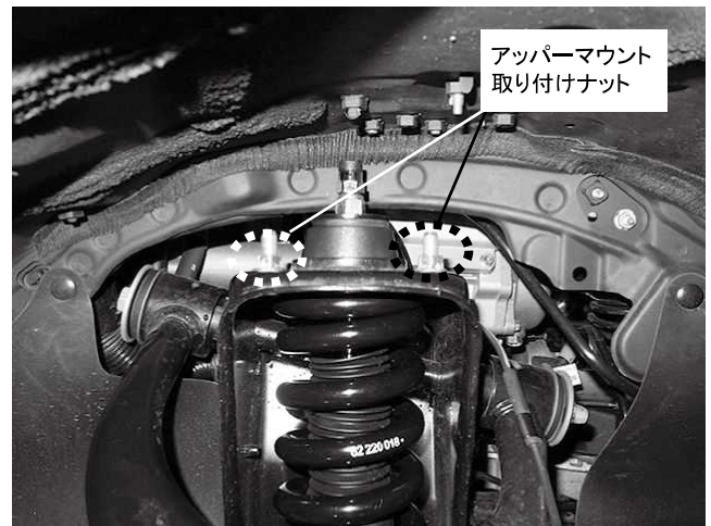
アッパーマウント 取り付けナット 3カ所締め付け 締め付けトルク: 64\text{N}\cdot\text{m} ( 6.5\text{kgf}\cdot\text{m} ) ※製品付属のM10ナットを使用してください
