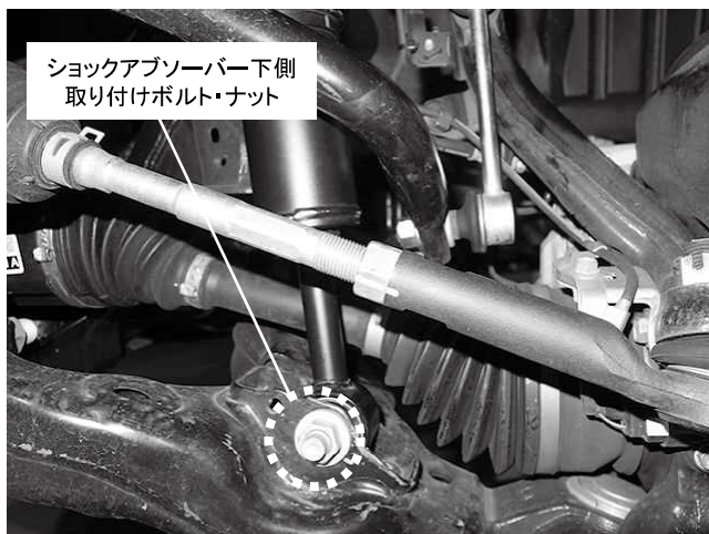
ショックアブソーバー下側 取り付けボルト・ナット 1カ所締め付け 締め付けトルク: 95\text{N}\cdot\text{m} ( 9.7\text{kgf}\cdot\text{m} )
