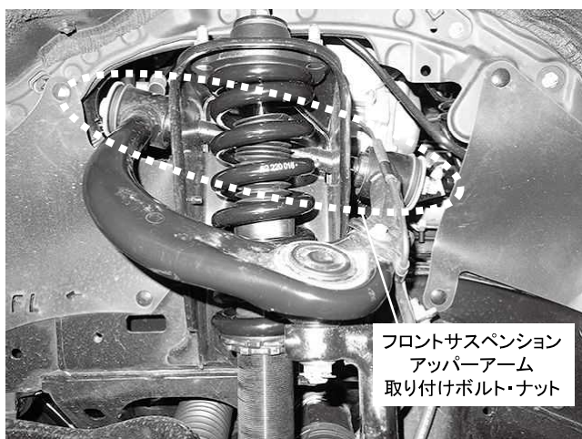
フロントサスペンション アッパーアーム 取り付けボルト・ナット 1カ所締め付け 締め付けトルク: 115\text{N}\cdot\text{m} ( 11.7\text{kgf}\cdot\text{m} )
