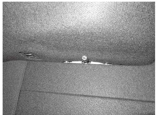
上写真は内装サイドパネルと ラゲージフロアマットを加工しないで 取り付けた状態です
