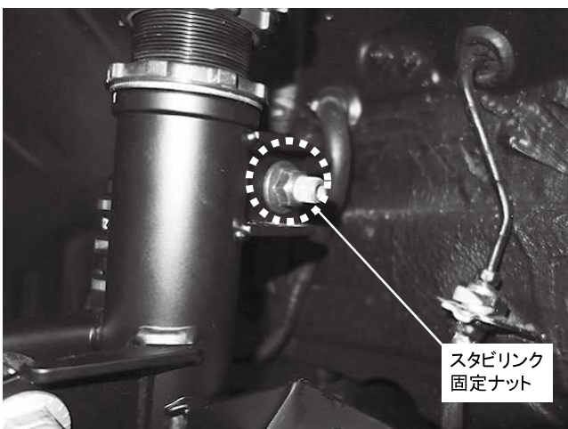
スタビリンク固定ナット 1カ所締め付け 締め付けトルク: 60N・m (6.1kgf・m)
