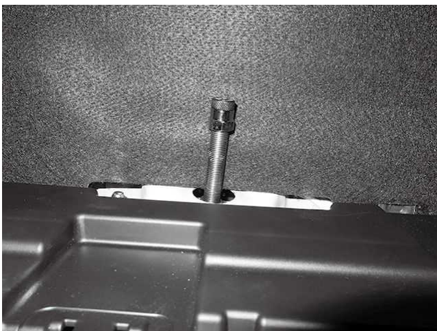
リアショック上部シャフト部分が上写真のように トランク内へ突き出すような構造になっています ※写真はラゲージフロアマットを取り外しています
