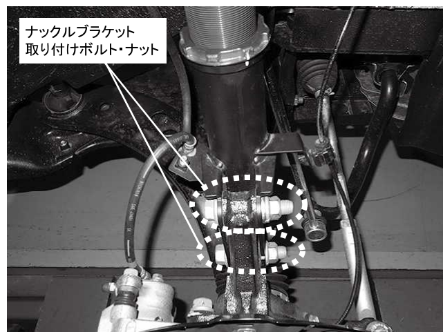
ナックルブラケット取り付けボルト・ナット 2カ所締め付け
