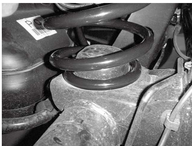
リアスプリングロア側取り付け状態 ※スプリングと車軸側の切り欠き位置が あっているか確認してください
