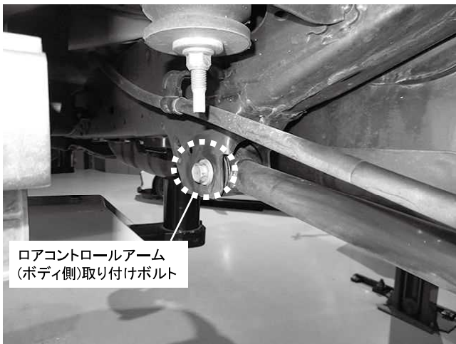
ロアコントロールアーム(ボディ側)取り付けボルト 1カ所締め付け 締め付けトルク: 130N・m(13.3kgf・m) ※アクスルビームをジャッキで支えながら取り付けし、 締め付けの際はしっかり車重をかけて締め付けてください
