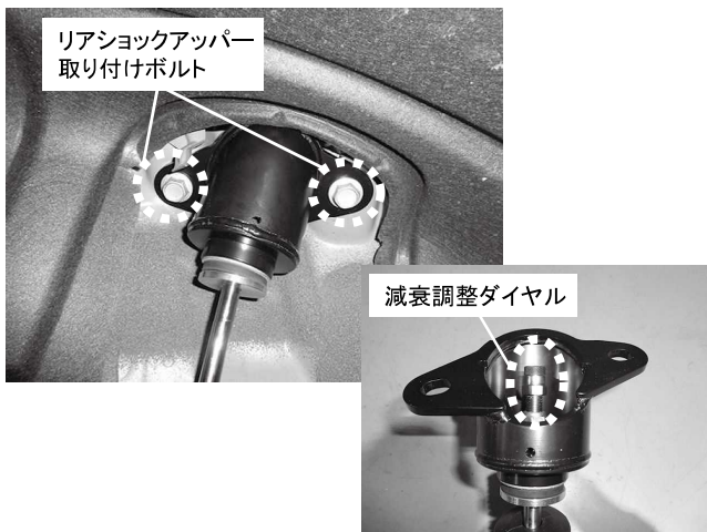
リアショックアッパース取り付けボルト 2カ所締め付け 締め付けトルク: 55\text{N}\cdot\text{m} ( 5.6\text{kgf}\cdot\text{m} ) ※減衰調整ダイヤルは構造上 アッパーマウント内部についています ※キット付属ダイヤルキャップを取り付けてください
