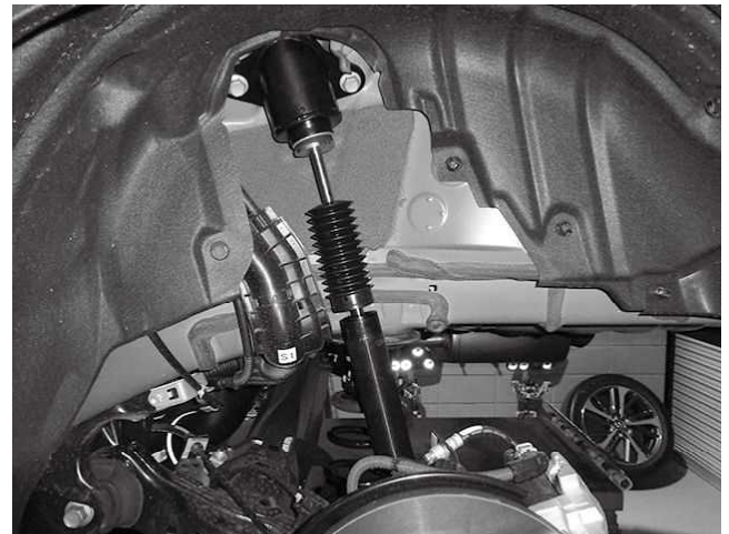
必要に応じて、タイヤハウス内のクリップを外し、 インナーフェンダーをめくると、リアショック上部に アクセスでき、減衰調整ダイヤルを回すことが可能です ダイヤルキャップを取り付けた状態で回すことができます
