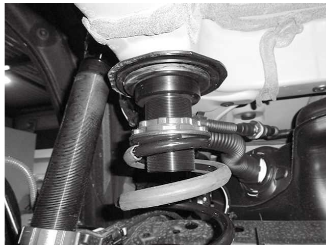
リアスプリング上側取り付け状態
