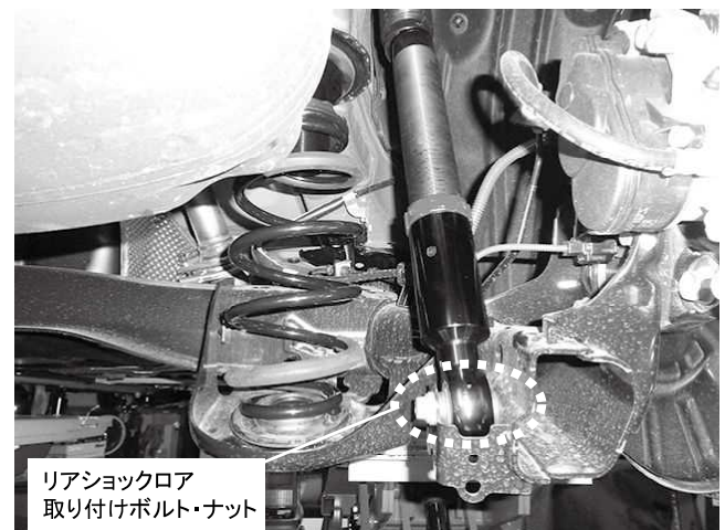
リアショックロア取り付けボルト・ナット 1カ所締め付け 締め付けトルク: 49\text{N}\cdot\text{m} ( 5.0\text{kgf}\cdot\text{m} )
