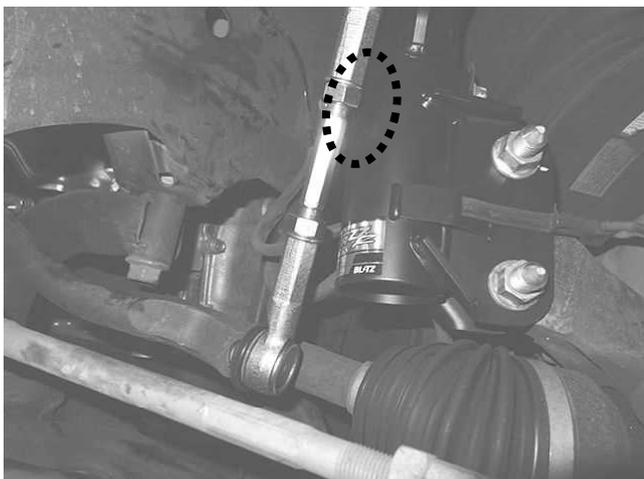
ステアリングを切るとスタビリンクとロアブラケット背面とのクリアランスが狭くなります ※上写真はCV5W 1G時
