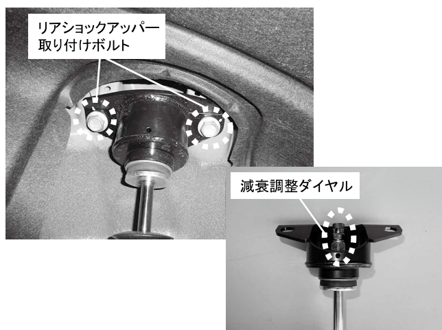
リアショックアッパ－取り付けボルト 2カ所締め付け 締め付けトルク: 60\text{N}\cdot\text{m} ( 6.1\text{kgf}\cdot\text{m} ) ※減衰調整ダイヤルは構造上 アッパーマウント内部についています ※キット付属ダイヤルキャップを取り付けてください
