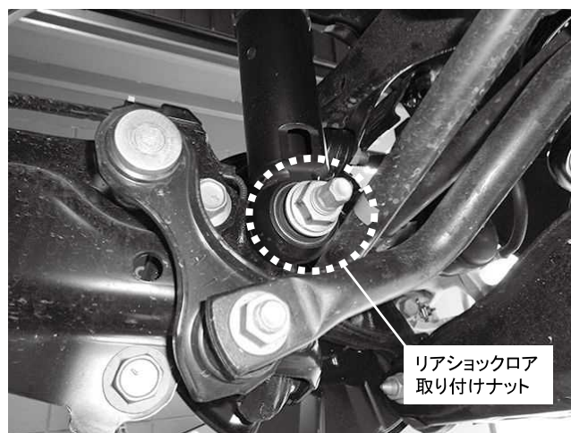
リアショックロア取り付けナット 1カ所締め付け 締め付けトルク: 135\text{N}\cdot\text{m} ( 13.7\text{kgf}\cdot\text{m} )
