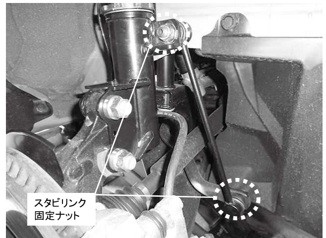
スタビリンク固定ナット 1カ所締め付け 締め付けトルク: 74N・m(7.5kgf・m) ※スタビリンクはキット付属品を使用してください
