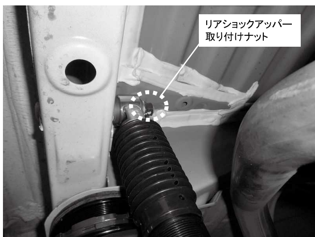
リアショックアッパー取り付けナット 1カ所締め付け 締め付けトルク: 43\text{N}\cdot\text{m} ( 4.4\text{kgf}\cdot\text{m} ) ※ワッシャー(純正品)も一緒に取り付けてください
