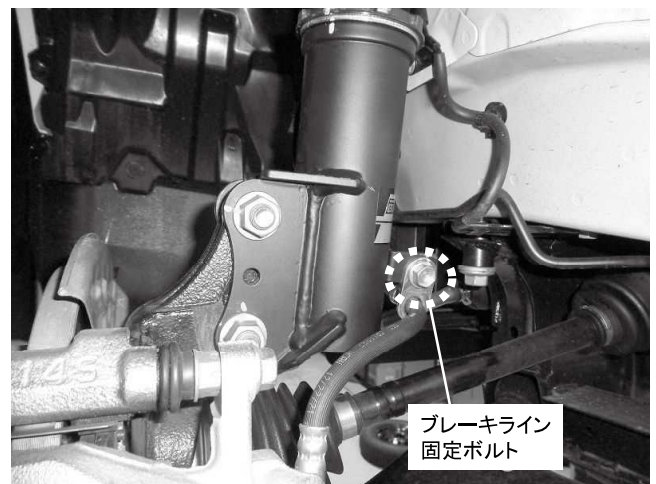
ブレーキライン固定ボルト 1カ所締め付け 締め付けトルク: 24N・m(2.5kgf・m)
