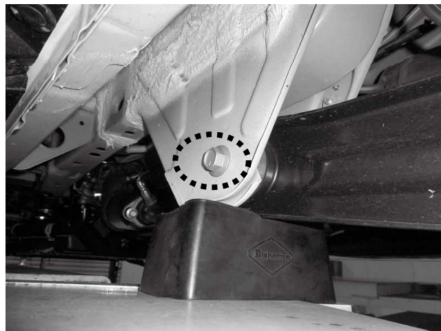
トレーリングアーム(ボディ付け根) 1ヵ所締め付け 締め付けトルク: 66\text{N}\cdot\text{m} ( 6.7\text{kgf}\cdot\text{m} ) ※一度緩めて1G状態で締め直しすることをお勧めいたします
