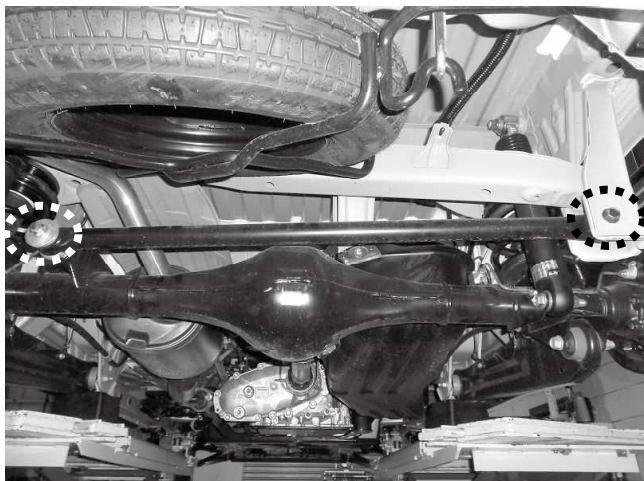
ラテラルロッド 2ヵ所締め付け 右(運転席)側 締め付けトルク: 66\text{N}\cdot\text{m} ( 6.7\text{kgf}\cdot\text{m} ) 左(助手席)側 締め付けトルク: 92\text{N}\cdot\text{m} ( 9.4\text{kgf}\cdot\text{m} ) ※一度緩めて1G状態で締め直しすることをお勧めいたします
