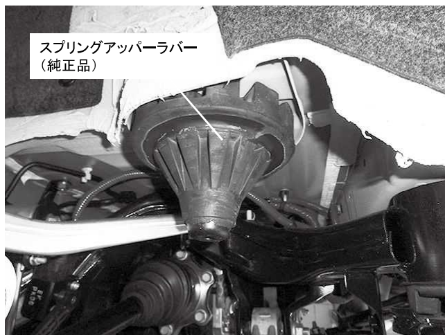
車両からスプリングアッパーラバー(純正品)を外します
