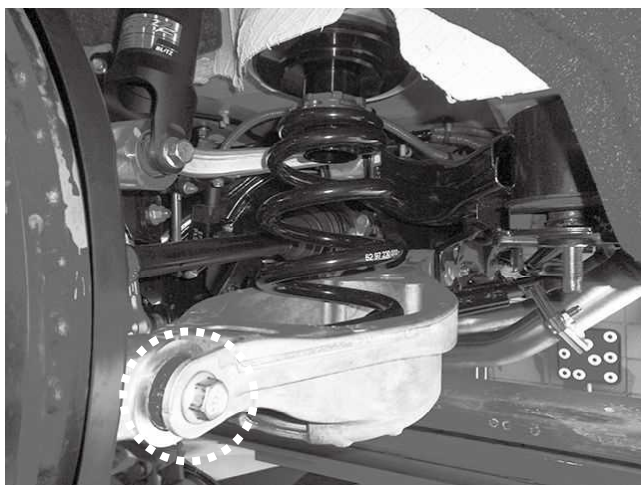
リアロアリンク取り付けボルト・ナット 1カ所締め付け 締め付けトルク: 72.5N・m(7.4kgf・m)
