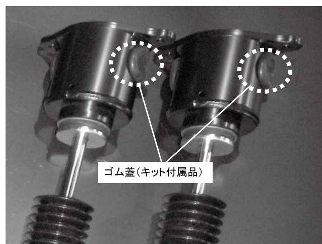
アッパーマウント内に砂利や水の侵入を防ぐ為、ゴム蓋をアッパーマウント1個につき2カ所取り付けしています 必ず取り付けたまま使用してください ※減衰力を調整する際はこのゴム蓋を外して調整してください
