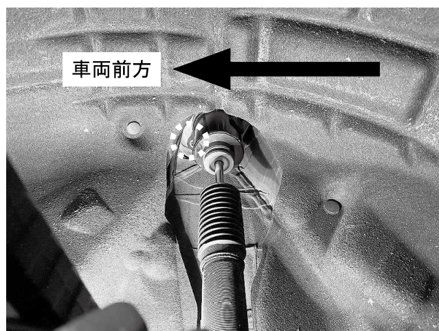
左(助手席)側リアショック取り付け状態 矢印の方向が車両前方側を示しています カラーは前方側のみに必ず取り付けください
