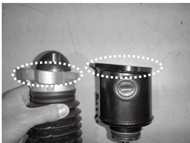
リアショックアッパーマウントは純正同様、 斜めになっています。取り付けの際は取り付け向きに 注意して取り付けてください。
