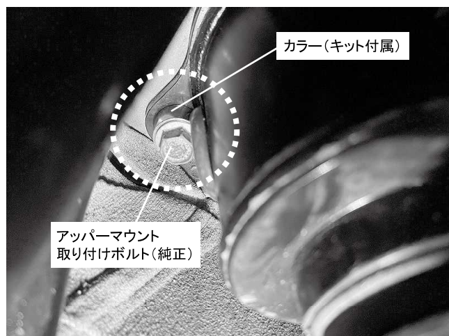
リアショックアッパーマウント取り付けボルト 2カ所締め付け 締め付けトルク: 40\text{N}\cdot\text{m} ( 4.1\text{kgf}\cdot\text{m} ) 必ず車両前方側ボルトにキット付属のカラーを取り付けてください ※車両後方側のボルトはそのまま車両へ取り付けてください
