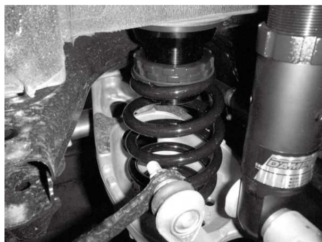
リアスプリング取り付け状態 ※写真はAWD車の取り付け状態になります
