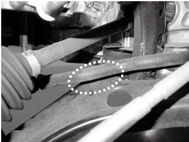
フロント左(助手席)側の取り付け後の写真になります ロアアームとスタビライザーが干渉していないか 確認してください ※写真は基準車高(寸法)の0G時状態です
