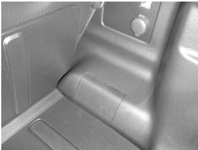
右(運転席)側内装パネル取り付け状態 ※加工せずサービスパネルは取り付け可能ですが 車両個体差により、パネルと減衰ダイヤルが 干渉する場合があります
