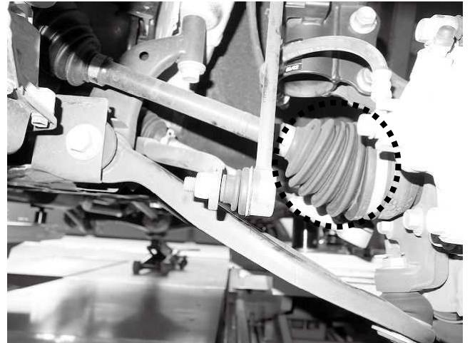
フロント左(助手席)アウト側のドライブシャフトとブーツの状態になります ※車高調整の際は、ドライブシャフトの傾きに注意してください ※リフトアップすることでドライブシャフトブーツに通常よりも多く負担がかかりますので、破損していないか定期的に確認を行ってください ※写真は基準車高(寸法)の0G時状態です
