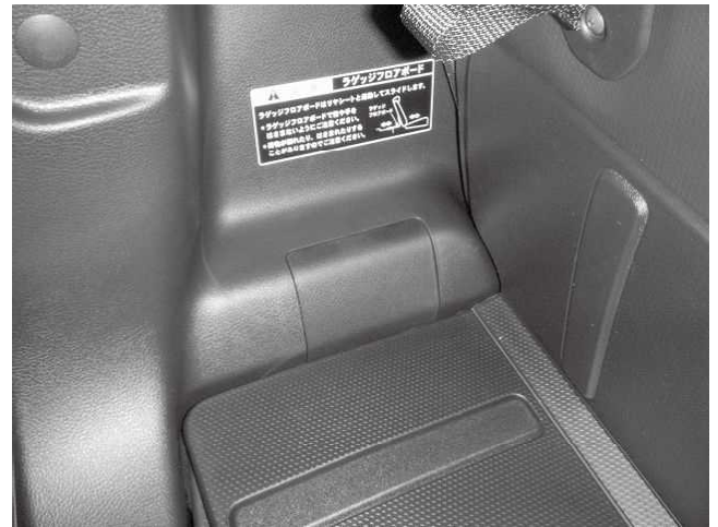
左(助手席)側内装パネル取り付け状態 ※加工せずサービスパネルは取り付け可能ですが 車両個体差により、パネルと減衰ダイヤルが 干渉する場合があります
