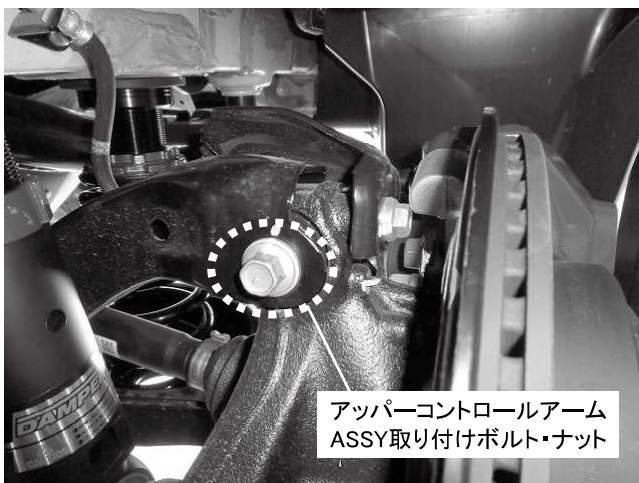
アッパコントロールアーム ASSY取り付けボルト・ナット 1カ所締め付け 締め付けトルク: 73N・m(7.4kgf・m) ※切り離さない場合でも一度緩めて1G状態で 締め直しをすることをお勧めいたします
