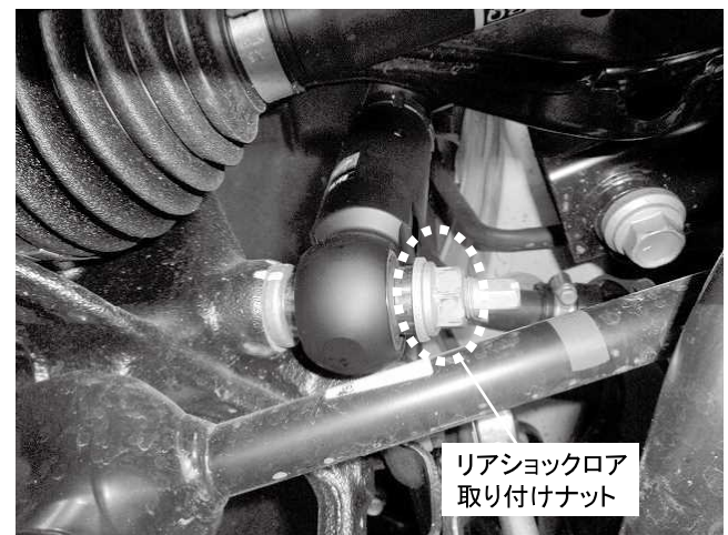
リアショックロア取り付けナット 1カ所締め付け 締め付けトルク: 135\text{N}\cdot\text{m} ( 13.8\text{kgf}\cdot\text{m} ) ※カラーがしっかり取り付けられているか確認してください
