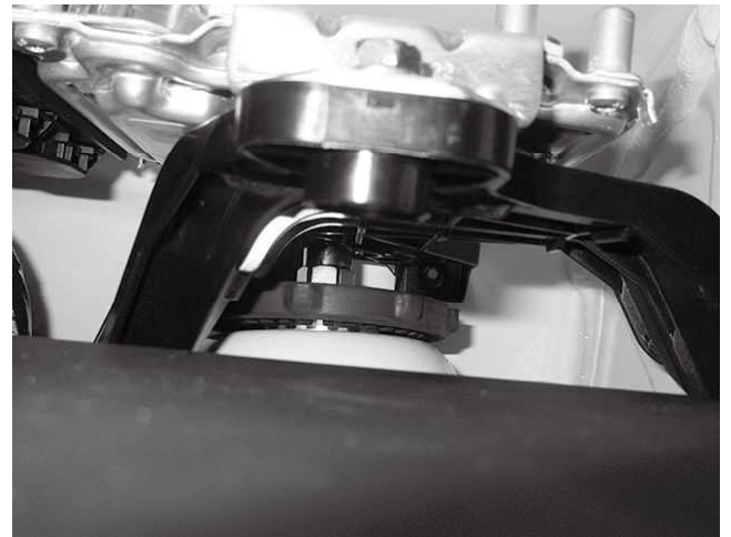
トップナット締め付け状態 左側(助手席側)のショック上部にECUがある為 作業時はECUをずらして作業を行ってください ※ずらす際、ECUの配線・コネクタの破損に 注意してください
