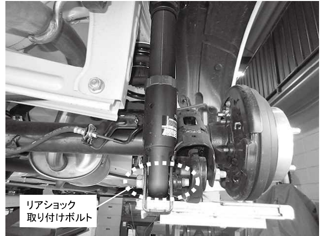
リアショック取り付けボルト 1ヵ所締め付け 締め付けトルク: 75\text{N}\cdot\text{m} ( 7.5\text{kgf}\cdot\text{m} ) ※アスクルビームをジャッキで支えながら取り付けし、 締め付けの際は車重をかけて締め付けてください
