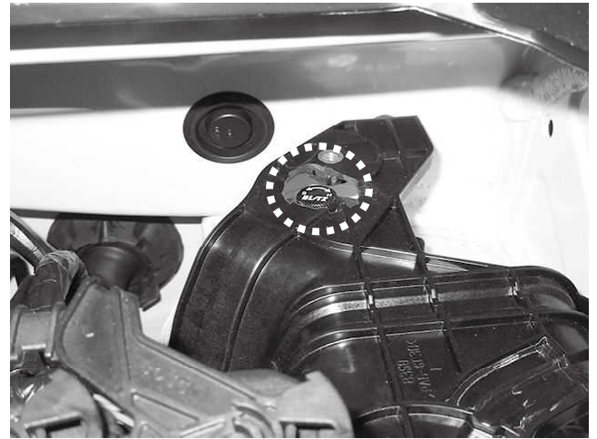
ECU固定ブラケット加工状態 左側(助手席側)のショック上部にECUがあり、 ECU固定ブラケットと減衰ダイヤルが干渉する 可能性があります その際は上写真のように加工をお願いします
