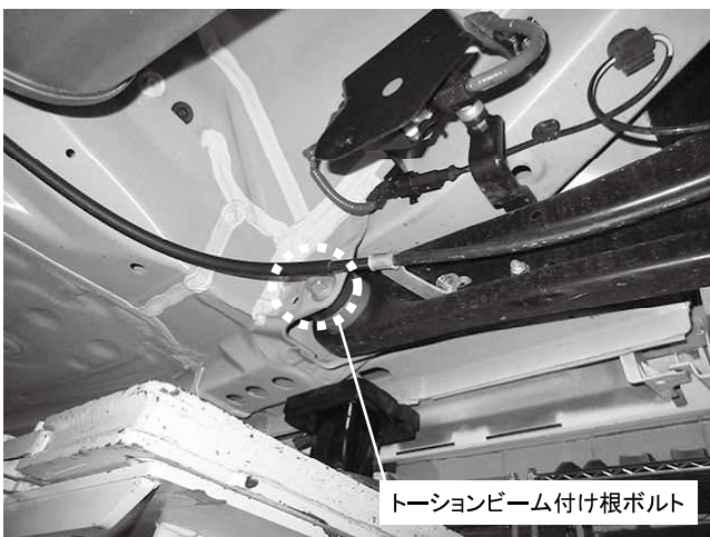
トーションビーム付け根ボルト 1ヵ所締め付け 締め付けトルク: 78\text{N}\cdot\text{m} ( 7.9\text{kgf}\cdot\text{m} ) ※一度緩めて1G状態で再度締め直しすることをお勧めいたします
