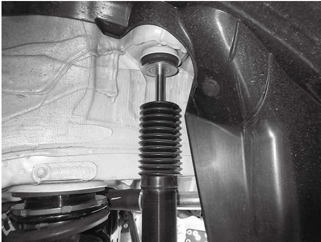
リアショック取り付け状態 ※ブッシュの取り付け方向に注意してください
