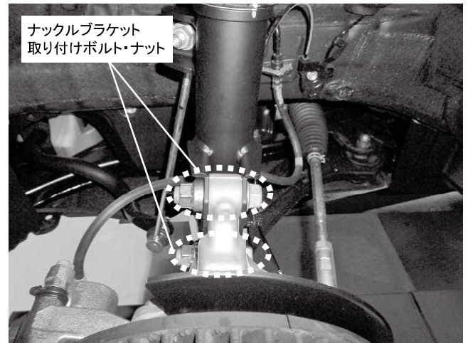
ナックルブラケット 取り付けボルト・ナット 2カ所締め付け 締め付けトルク: 290N・m (29.6kgf・m)
