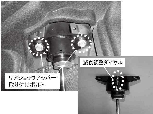
リアショックアッパース取り付けボルト 2カ所締め付け 締め付けトルク: 55N・m (5.6kgf・m)
