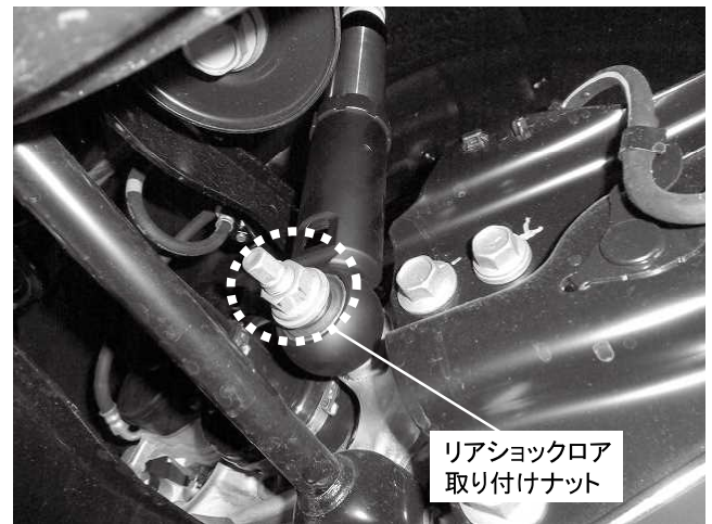
リアショックロア取り付けナット 1カ所締め付け 締め付けトルク: 125N・m (12.8kgf・m) ※カラーがしっかり取り付けられているか 確認してください
