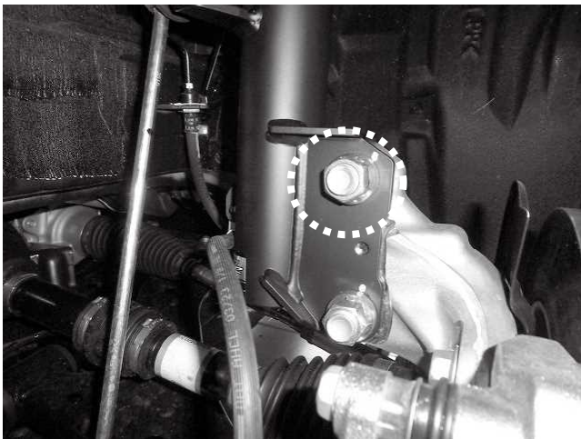
ショックアブソーバーナックルブラケット上側取り付け穴は 長穴になっており、キャンバーの調整が可能です 左右で位置を合わせて取り付けてください
