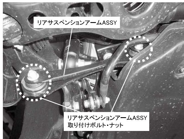
リアサスペンションアームASSY取り付けボルト・ナット 2カ所締め付け
