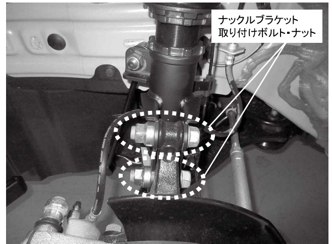
ナックルブラケット取り付けボルト・ナット 2カ所締め付け 締め付けトルク: 270N・m(27.5kgf・m)
