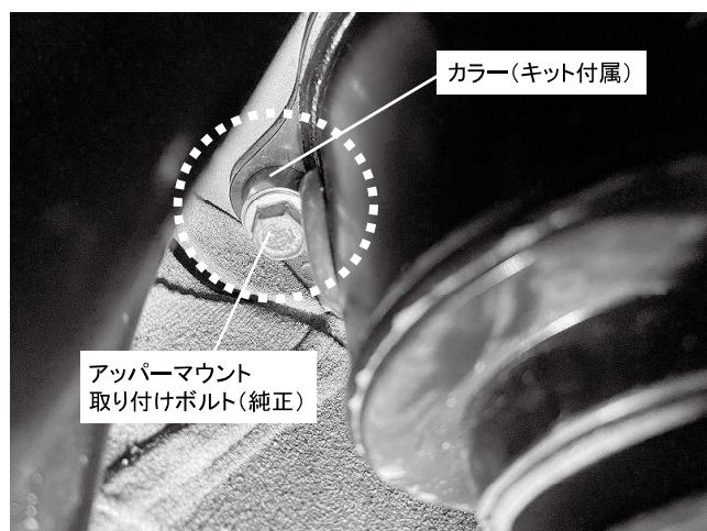
左側リアショックアッパーマウント取り付けボルト 2カ所締め付け 締め付けトルク: 40\text{N}\cdot\text{m} ( 4.1\text{kgf}\cdot\text{m} ) 必ず車両前方側ボルトにキット付属のカラーを取り付けてください ※車両後方側のボルトはそのまま車両へ取り付けてください
