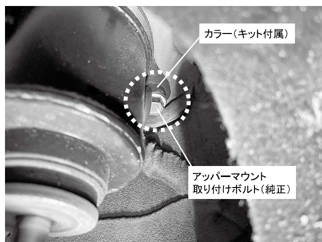
右側リアショックアッパーマウント取り付けボルト 2カ所締め付け 締め付けトルク: 40\text{N}\cdot\text{m} ( 4.1\text{kgf}\cdot\text{m} ) 必ず車両前方側ボルトにキット付属のカラーを取り付けてください ※車両後方側のボルトはそのまま車両へ取り付けてください
