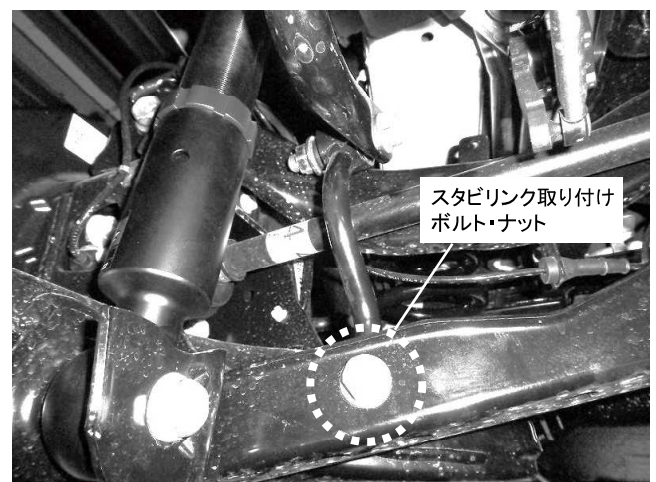
スタビリンク取り付けボルト・ナット 1カ所締め付け 締め付けトルク: 110\text{N}\cdot\text{m} ( 11.2\text{kgf}\cdot\text{m} )
