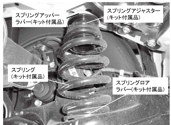
リアスプリング取り付け状態 ※上下のスプリングラバーが しっかりはまっているか確認してください
