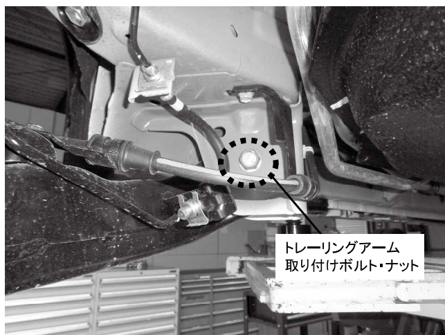
トレーリングアーム取り付けボルト・ナット 1カ所締め付け 締め付けトルク: 158\text{N}\cdot\text{m} ( 16.1\text{kgf}\cdot\text{m} ) ※一度緩めて1G状態で締め直しすることをお勧め致します
