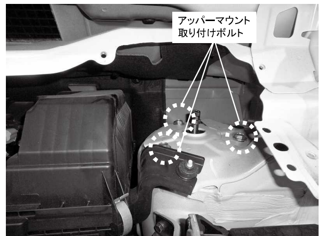
アッパーマウント 取り付けボルト 3カ所締め付け 締め付けトルク: 22N・m(2.2kgf・m) ※ボルトは純正品を使用してください
