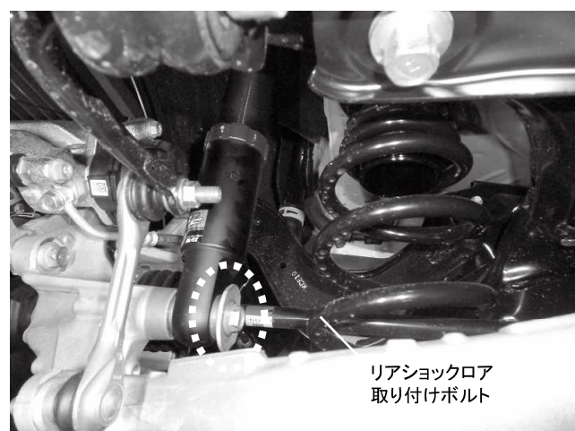
リアショックロア取り付けボルト 1カ所締め付け 締め付けトルク: 78\text{N}\cdot\text{m} ( 8.0\text{kgf}\cdot\text{m} ) ※ワッシャーも取り付けください
