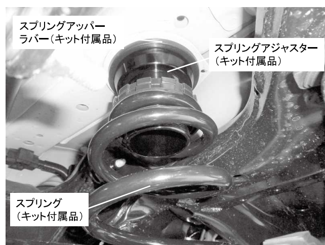
リアスプリング取り付け状態 (アッパー側)
