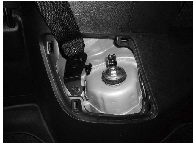
トップナット締め付け状態
