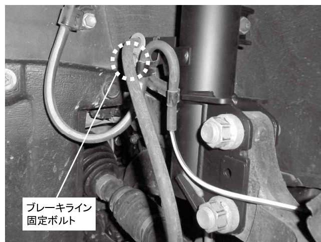
ブレーキライン固定ボルト 1カ所締め付け 締め付けトルク: 18.5N・m(1.9kgf・m) ※ネジ部に塗装がついて締め付けが渋い場合があります ※スピードセンサーハーネスと共締めしてあります
