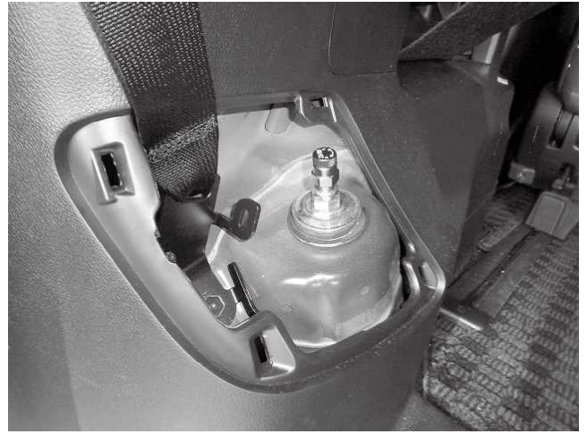
トップナット締め付け状態 ※写真はサービスパネルを外した状態です
