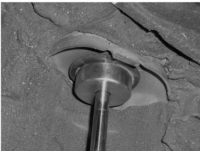
リアショック取り付け状態 ※車両・型式・年式によってロアブッシュの形状が写真と異なる場合があります
