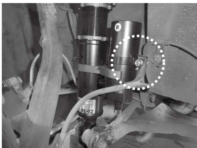
リザーバータンクについているバンドを使用し スピードセンサーハーネスを取り付けてください。 ※ハンドルを切った時の張り具合も確認してください。
