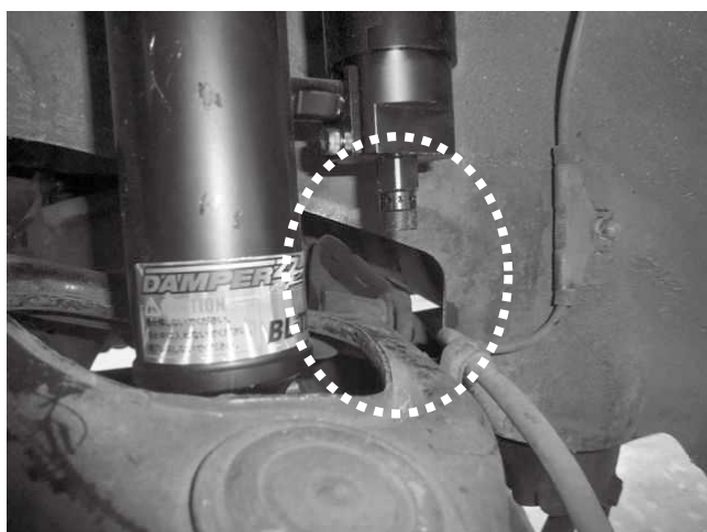
リザーバートankとアッパーアームとの 干渉に注意してください。 ※車高を下げる場合特に注意してください。
