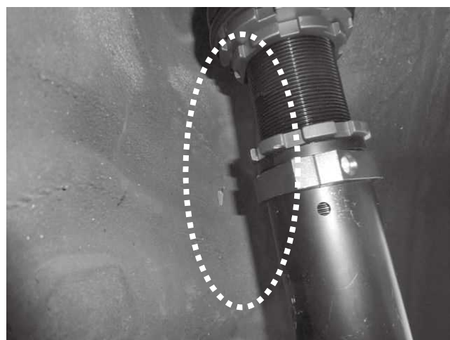
ショックアブソーバーASSYと インナーフェンダーとの干渉に注意してください。
