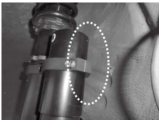
リザーバートank(固定ステー)と インナーフェンダーとの干渉に注意してください。
