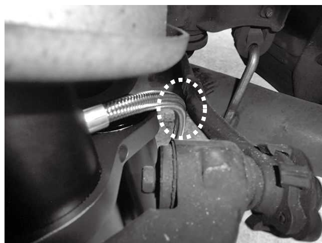
ストロークした時、メッシュホースとハイキャス タイロッドが接触します。同梱スパイラルチューブを メッシュホースに巻き保護してください。
