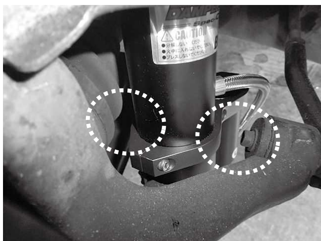
リザーバートank(固定ステー)と ナックル、ドライブシャフトブーツとの干渉に 注意してください。
