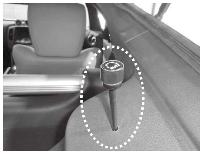
減衰力延長ダイヤル取り付け状態 ※付属延長ダイヤルの長さでハッチと干渉する場合は 短く切るなどしてください。異音の原因となります。
