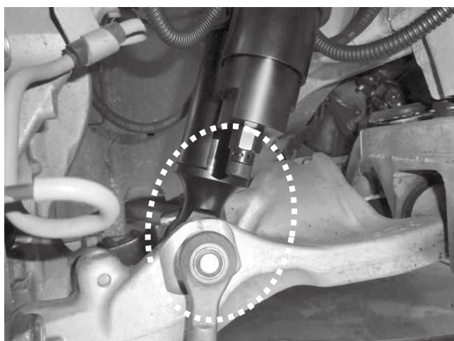
リザーバータンクとスタビリンクとの 干渉に注意してください。 ※車高を下げる場合特に注意してください。
