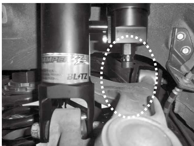
ザーバータンクとアッパーアームとの 干渉に注意してください。 ※車高を下げる場合特に注意してください。
