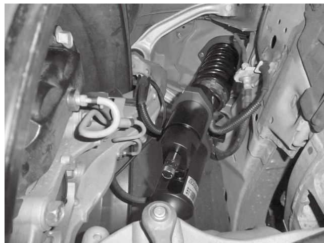
フロント タイヤ・ホイールクリアランス ※取り付け後クリアランス確認をお願いします。
