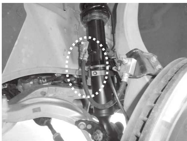
リザーバータンク固定ステーとブレーキラインとの 干渉に注意してください。
