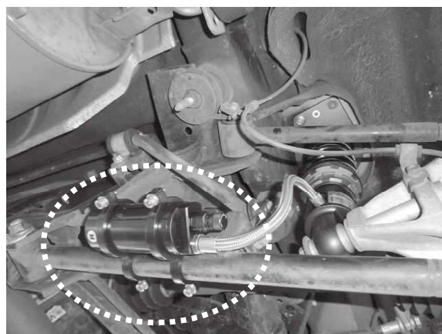
リザーバータンク固定バンドのボルトは 定期的な緩みなど確認を行ってください。 ※タンクが脱落すると重大な事故につながります。
