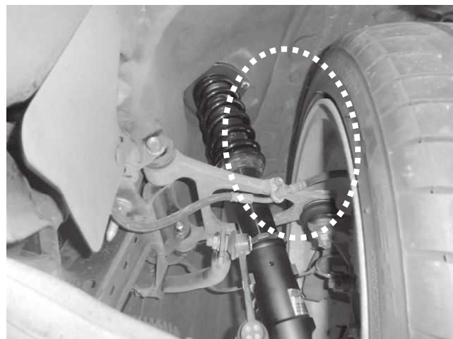
フロント タイヤ・ホイールクリアランス 純正ホイール(18インチ)・タイヤ装着状態 ※取り付け後クリアランス確認をお願いします。
