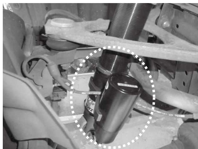
リザーバータンクと近接アームなどとの クリアランスに注意してください。
