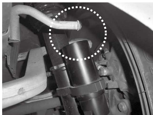
リザーバタンクとマフラステーが干渉する際は、マフラーの取り付けに支障がない様にステーなどの加工をお願いいたします。
