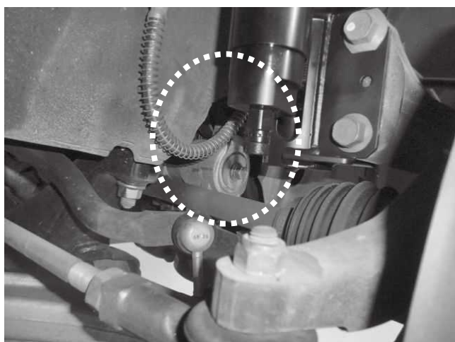
ブレーキラインとリザーバータンク、 ドライブシャフトとの干渉に注意してください。
