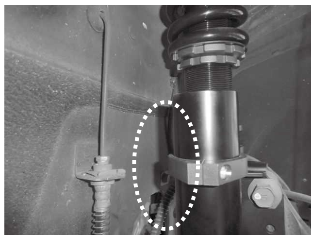
リザーバータンク(固定ステア)と インナーフェンダーとの 干渉に注意してください。
