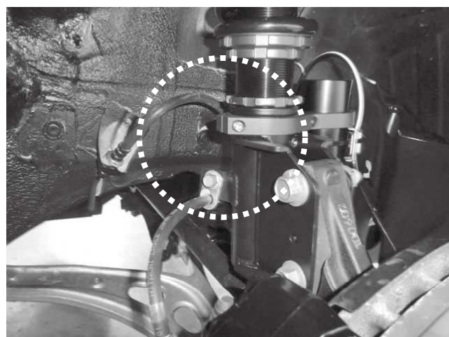
リザーバータンク固定ステー、ロックシートと ブレーキライン、インナーフェンダーとの干渉に 注意してください。
