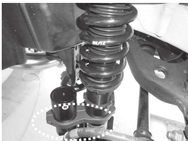
リザーバタンク固定ステーと ブレーキキャリパー・ブレーキラインとの干渉に 注意してください。
