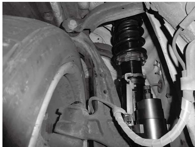
フロント タイヤ・ホイールクリアランス 18×8.0J INSET35 235/40R18装着状態 ※取り付け後クリアランス確認をお願いします。
