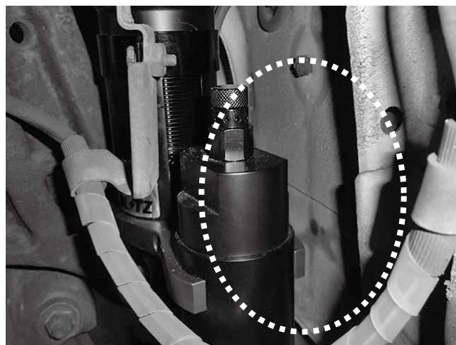
リザーバータンクと インナーフェンダーとの干渉に 注意してください。
