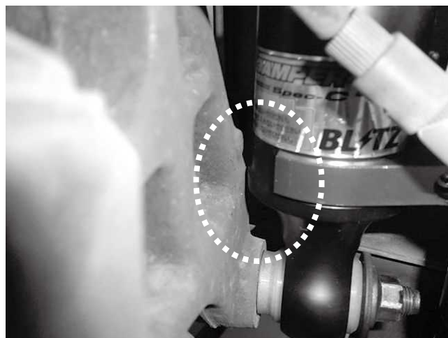
ロアブラケットとナックルが非常に近く、 車両によっては干渉の可能性がありますので、 予めご了承ください。
