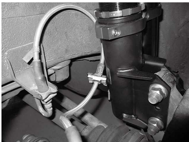
ブレーキラインに突っ張りや干渉がないか 注意してください。 ※上写真は社外メッシュホースに変わっています。
