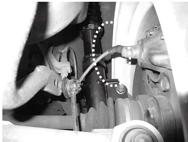
リア タイヤ・ホイールクリアランス 18×8.0J INSET43 + 10mm 225/40R18装着状態 ※取り付け後クリアランス確認をお願いします。
