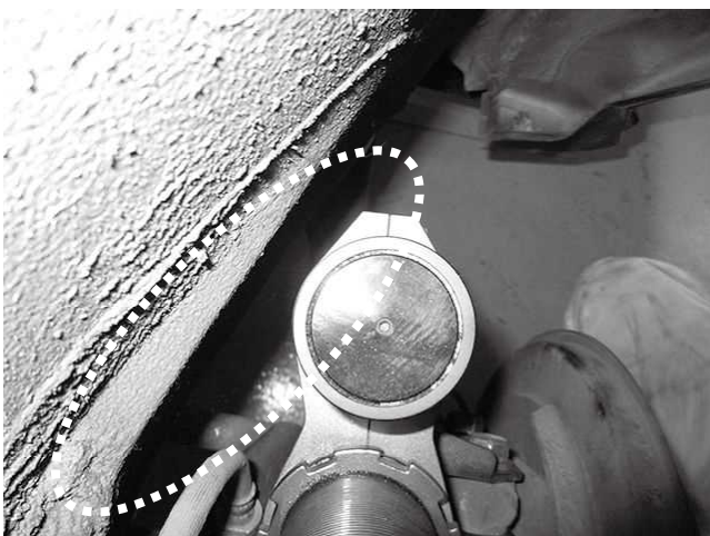
ボディとリザーバータンク固定ステー、 ブレーキラインとの干渉に注意してください。
