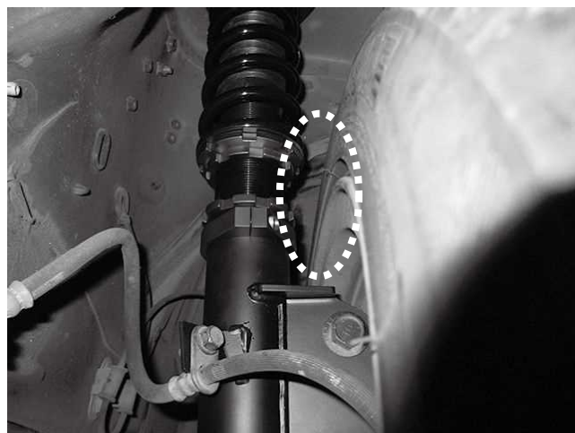
フロント タイヤ・ホイールクリアランス 純正タイヤ・ホイール装着状態 ※取り付け後クリアランス確認をお願いします。
