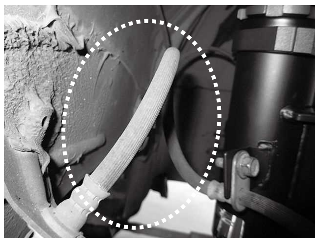
ブレーキラインの突っ張り、ボディとの干渉に 注意してください。
