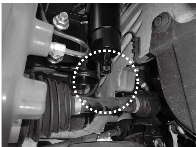
リザーバートankとドライブシャフトとの 干渉に注意してください。
