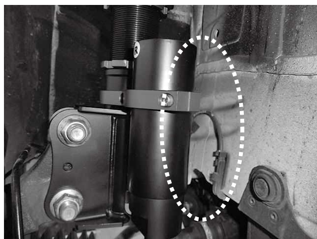
リザーバートank(固定ステー)と ボディとの干渉に注意してください。 ステアリングを切った時の干渉も確認してください。
